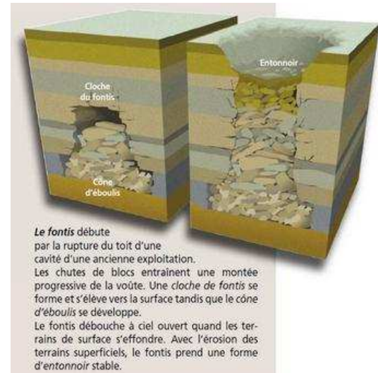
Illustration du phénomène d'effondrement localisé
