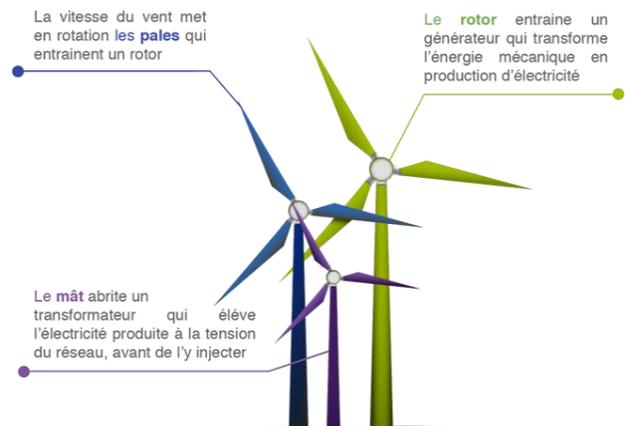
Figure 21 : Schéma de fonctionnement des éoliennes (Source : ENGIE)
